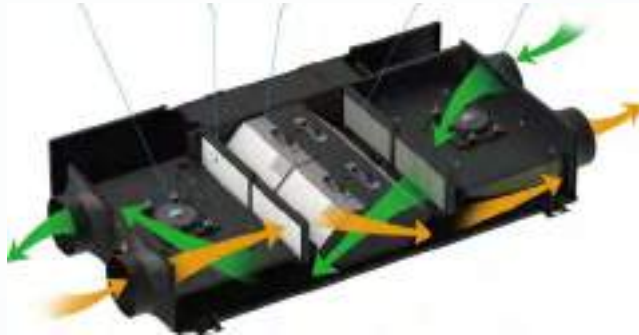
Припливний вентилятор Фільтр Рекуператор Фільтр Витяжний вентилятор
